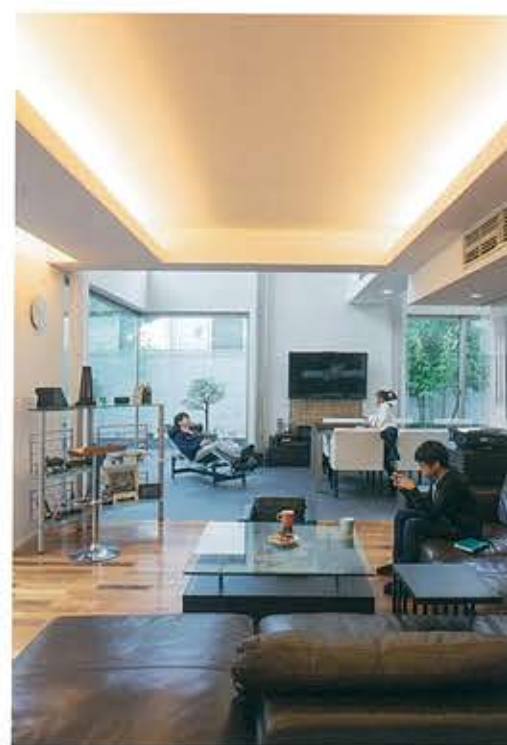
1階のリビングダイニングは、テラス側に全面強化ガラスを採用。窓のような縦桎がない「透明の壁」として屋内外の一体感を生んでいる。床材をテラスと同じ黒のタイル材にしたことも効果的
